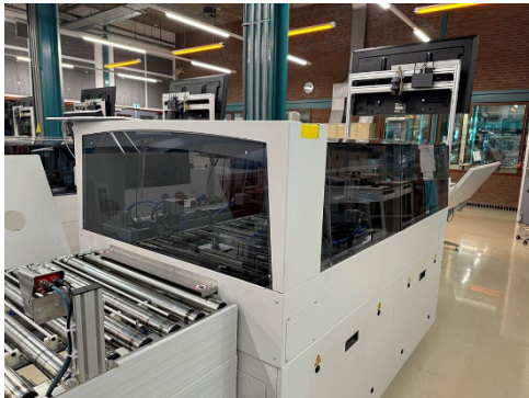
Voorbeelden van volledige afscherming van machines (bron: Grafimedia)
