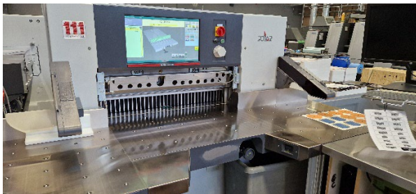
Voorbeeld van een snijmachine met tweehandenbediening (bron: Grafimedia)
