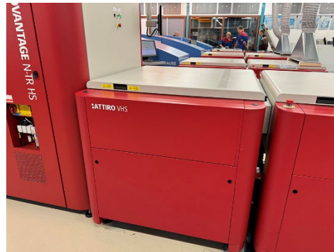
Voorbeelden van volledige afscherming van machines (bron: Grafimedia)
