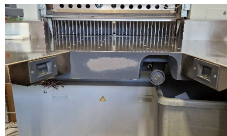
Voorbeeld van een snijmachine met tweehandenbediening (bron: Grafimedia)
