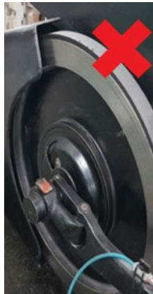
Voorbeeld van een verkeerde beschermkap
