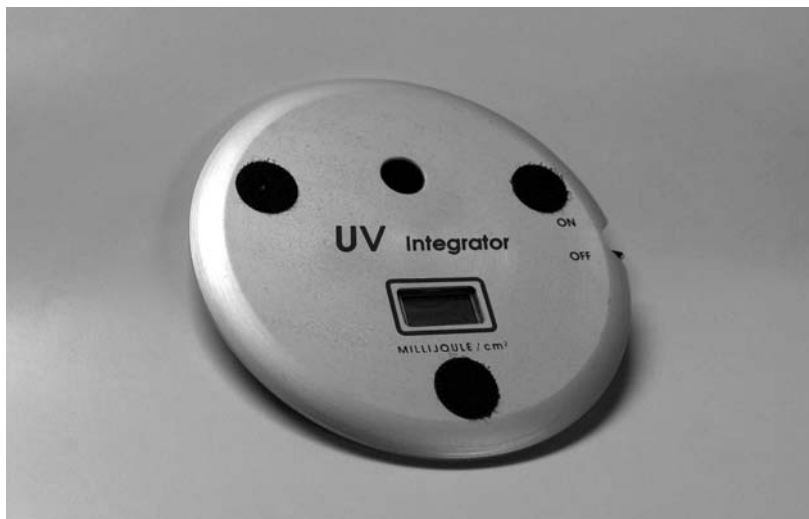
Figuur 5.1: De UV-integrator is een onmisbaar instrument. Meet regelmatig de UV-lamp(en) om te weten dat ze nog goed functioneren. Vanwege de grote meetverschillen tussen meters onderling wordt aangeraden de UV-integrator te gebruiken als referentie binnen uw bedrijf.
