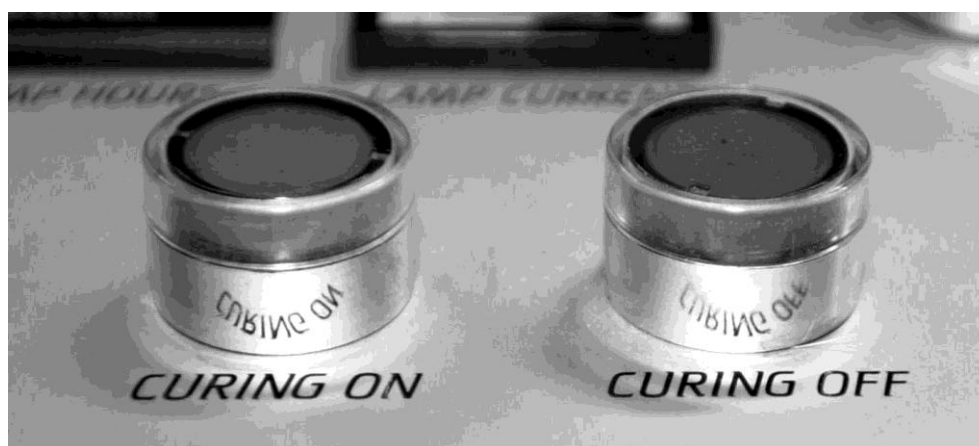
Figuur 8.1: Aan/uit schakelaars van de UV-lamp(en)
