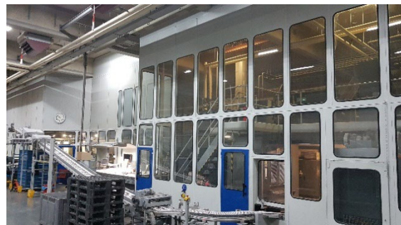
Voorbeeld van een rotatiedrukpers die omkast is
